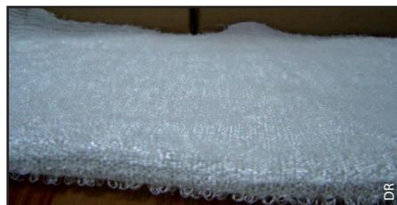
Les tissus 3D Han sont une nouvelle technologie mise au point par Advanced Fiber Materials Technologies, Co., Ltd., qui consiste à appliquer du velcro (fixation par boucles et barbules) sur les deux faces des nappes de fibres afin de produire des composites 3D très résistants au délaminage. Une demande de brevet international a été déposée.
