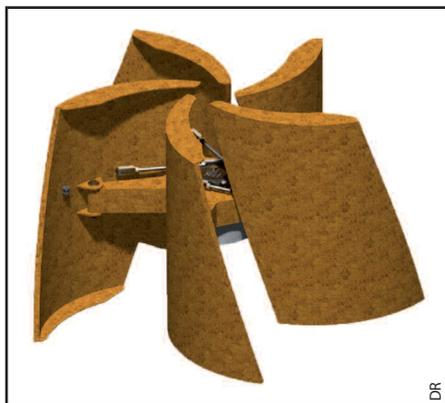
Le matériau associe des fibres de lin et une matrice en PLA, il est donc entièrement biodégradable.
