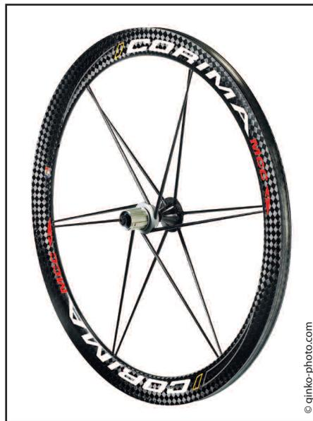
La roue entièrement en carbone CORIMA AERO+ MCC est réalisée à l'aide d'un procédé 100 % composite. La jante est constituée de fibre de carbone préimprégnée (Hexcel) enroulée autour d'une mousse en Rohacell (Evonik). Les rayons et une partie du moyeu sont aussi réalisés en fibre de carbone préimprégnée. Certaines pièces sont surmoulées alors que
